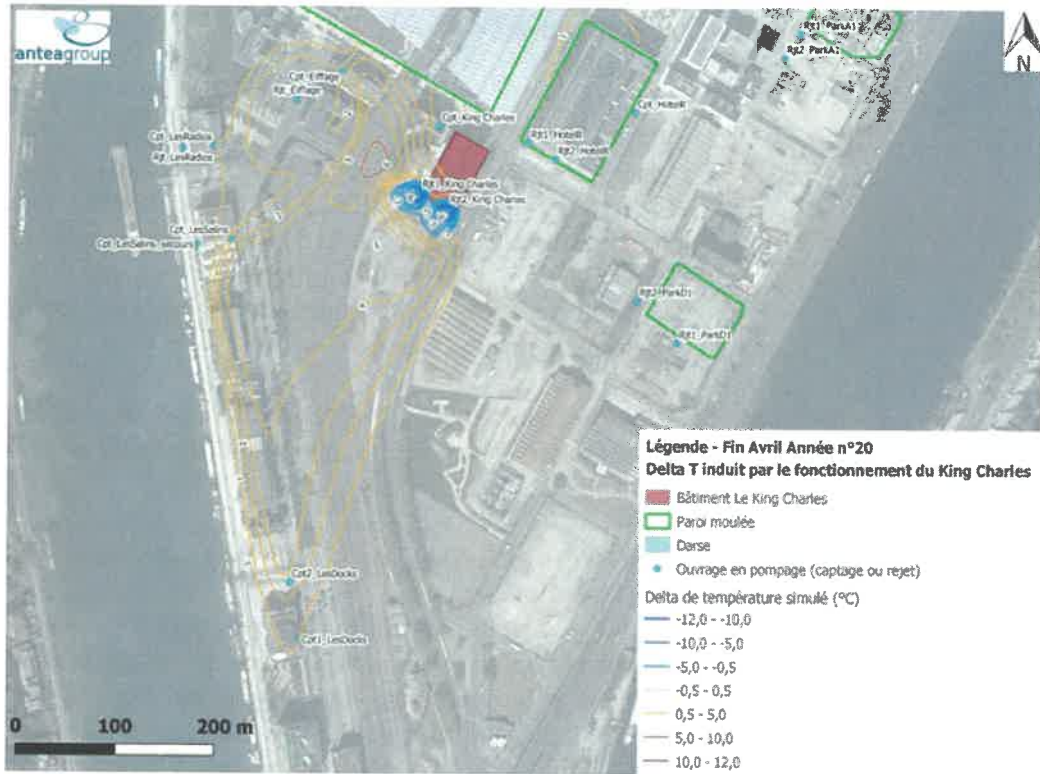
Figure 21 : Impact thermique de l'installation du King Charles au mois d'octobre au bout de 20 ans d'exploitation
