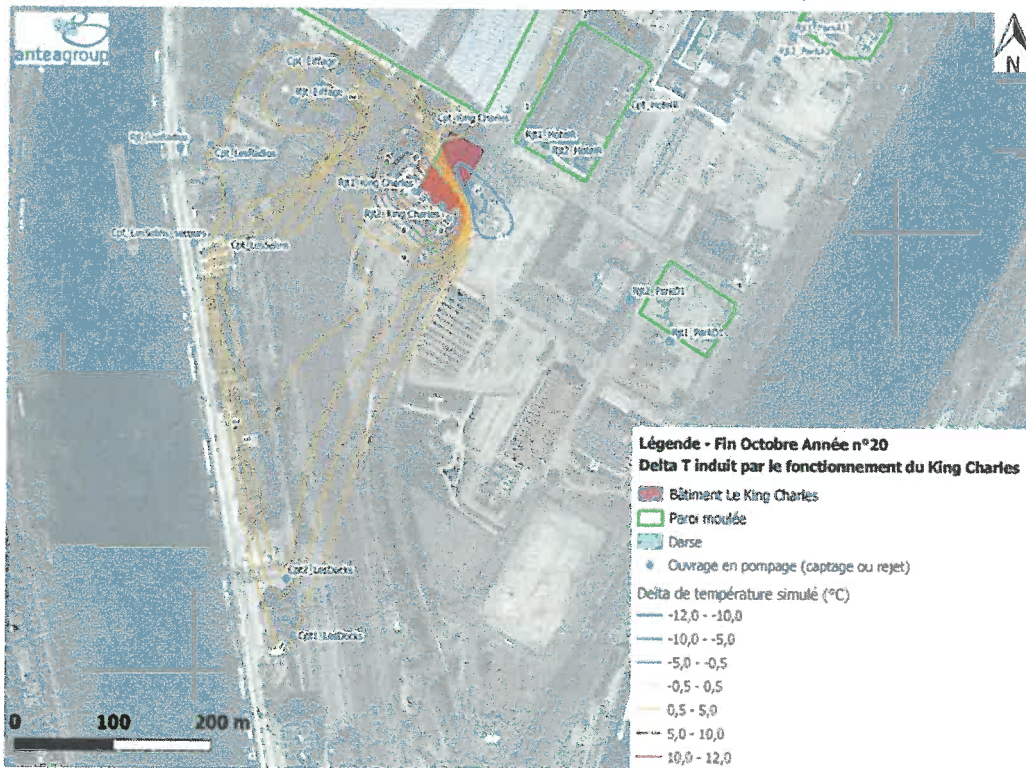
Figure 21 : Impact thermique de l'installation du King Charles au mois d'octobre au bout de 20 ans d'exploitation
